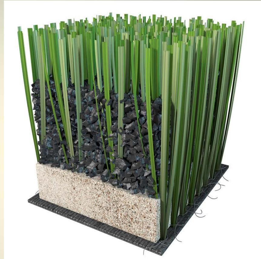
Para la fabricación de estos céspedes artificiales, se emplean fibras de polietileno o nylon, que se tejen sobre una urdimbre que se denomina backing quedando los penachos unidos a esa base mediante la aplicación de resinas de poliuretano que fijan el conjunto.
